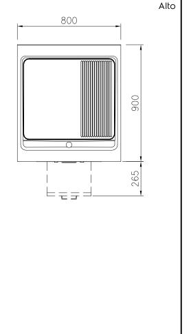
**Elettrico** Tensione di alimentazione: 400 V/3N ph/50/60 Hz Watt totali: 15.3 kW Informazioni chiave Profondità superficie di cottura: 615 mm Larghezza superficie di cottura: 700 mm 80 °C Temperatura MIN: Temperatura MAX: 280 °C Dimensioni esterne, 800 mm larghezza: Dimensioni esterne, profondità: 900 mm Dimensioni esterne, altezza: 250 mm Peso netto: 120 kg Tipologia superficie di cottura: 2/3 liscia e 1/3 rigata Superficie di cottura -Chromium Plated mild steel materiale mirror Sostenibilità
